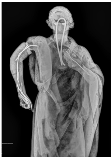
Radiografia X da escultura, ressaltando os fios metálicos de sustentação estrutural implantados no interior da imagem de gesso e os olhos de vidro maciços com hastes metálicas.
