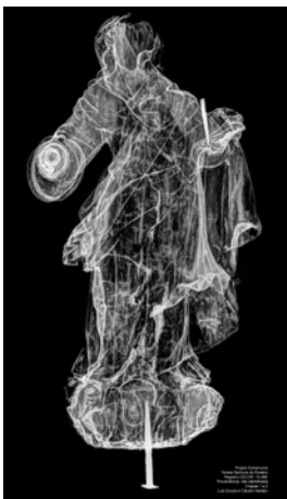
Radiografia X, enfatizando as áreas de perda de suporte, galerias por ataque de cupins e cravos
