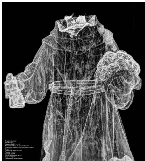
Detalhe da radiografia do corpo da imagem de São Benedito sem a cabeça. As áreas mais escuras são indicativo de galerias na madeira causadas por intenso ataque de cupins. Fonte: CECOR/Luiz A.C.Souza
