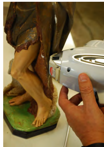
Exame de Fluorescência de Raio X – FTIR para identificação dos pigmentos.
