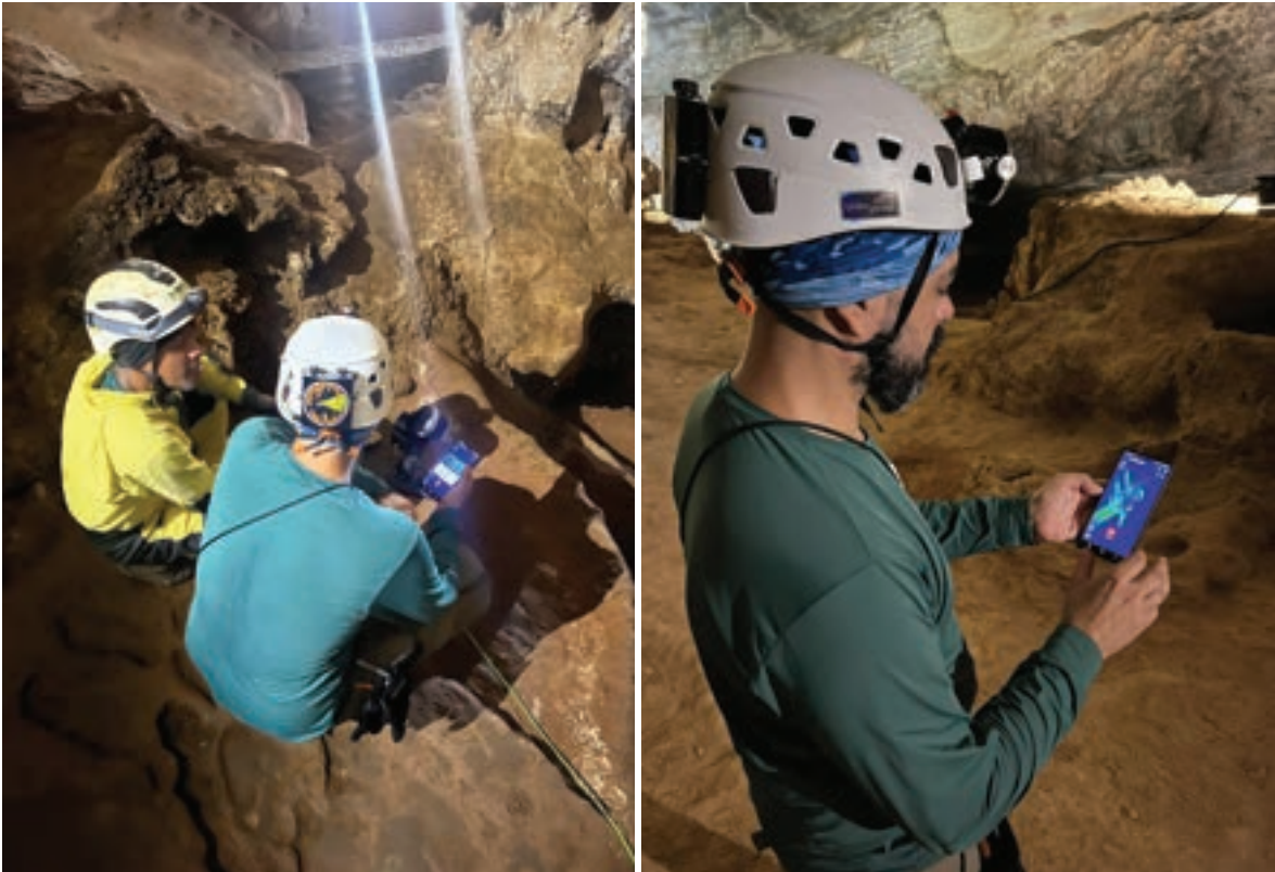
Figura 6.19. Operação do SLAM100 durante a execução do escaneamento da Gruta do Maquiné (Fotos: Diego Lara, 2024).
