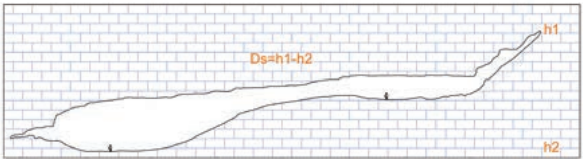
Figura 6.24. Obtenção do desnível do piso da Gruta do Maquiné, em metros.
